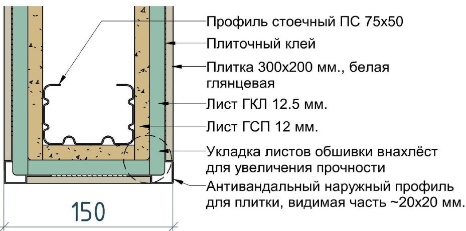
Перегородка с усилением (плитка Калейдоскоп Графит)
